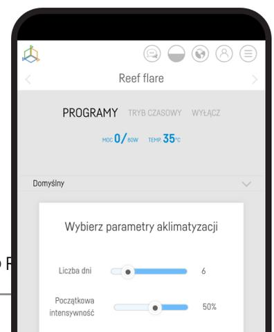
unerwünschten Reaktionen der Tiere in Ihrem Becken führen. Zu diesem Zweck verfügt unsere Lampe über eine Akklimatisierungsfunktion. Sie ermöglicht es Ihnen, die Lichtleistung schrittweise zu erhöhen, indem Sie die anfängliche Lichtleistung (standardmäßig 50 %), die Akklimatisierungszeit (von zwei bis dreißig Tagen) und die endgültige Lampenleistung (standardmäßig 100 %) auswählen.
