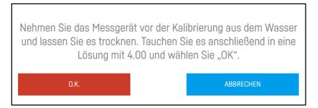
**5.** Legen Sie die pH-Sonde in die pH4-Lösung und drücken Sie die Schaltfläche
