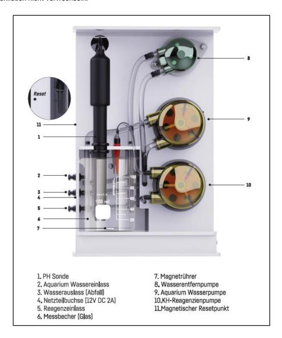
2. Achten Sie besonders auf die korrekte Verbindung der Schläuche mit den Flüssigkeiten (Aquariumwasser, Reagenz) und des Abflusses mit dem Abwasserbehälter.
