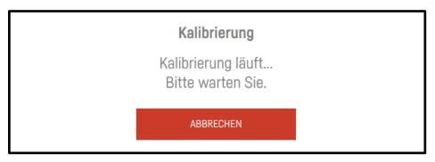
**24.** Schätzen Sie die Reagenzmenge in dem kleinen Behälter und tragen Sie deren ungefähren Wert in Millilitern in die Tabelle ein. Bestätigen Sie anschließend mit OK. Versuchen Sie diesen Wert möglichst genau anzugeben (z. B. bis auf eine Dezimalstelle). Für die Kalibrierung können Sie eine Präzisionswaage mit einer Messgenauigkeit von 0,01 g verwenden. Dadurch wird die Kalibrierung der Pumpe noch genauer.
