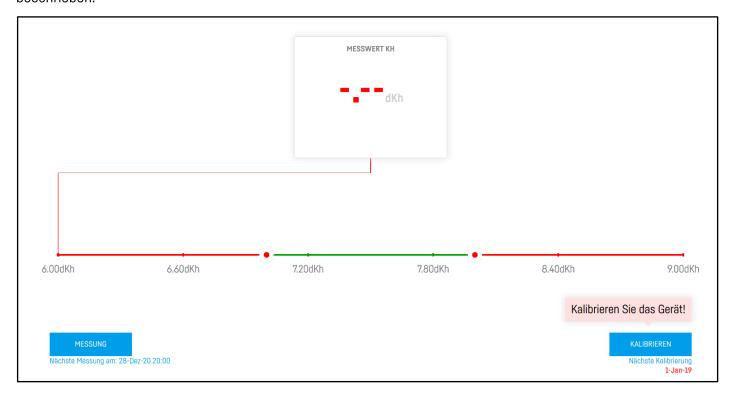
Sie können den Bereich für den KH-Wert jederzeit an die Vorgaben Ihres Aquariums anpassen, indem Sie die roten Punkte nach links oder rechts ziehen. Auf diese Weise legen Sie die Ober- und Untergrenze des KH-Werts fest. Die Bereichsskala wird automatisch geändert und passt sich selbst an die gewählten Werte an. Die Messung erfolgt mit einer Genauigkeit von zwei Dezimalstellen von 0,01 dKH.
