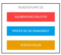
Zur korrekten Kalibrierung der Pumpe befüllen Sie das Steigrohr für das Reagenz mithilfe der Funktion System Füllen.
