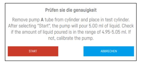
**26.** Wenn Sie START gedrückt haben, werden 5 ml der Flüssigkeit mit einer Genauigkeit von +/- 0,05 ml gepumpt. Ist die Flüssigkeitsmenge größer oder kleiner, müssen Sie Pumpe A neu kalibrieren.
