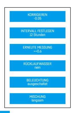
**37.** Die Funktion ermöglicht es, den gemessenen KH-Wert an den in einer anderen Referenzmessung erfassten Wert anzupassen. Beispiel: Wenn der vom Gerät gemessene KH-Wert
